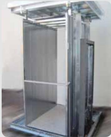
Grundkonstruktion und Boden (Tränenblech) feuerverzinkt, Kabinenwände feuerverzinkt, keine Decke nur Dachrahmen, Laufwagen zinkstaubgründiert
