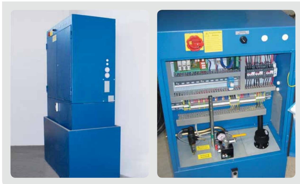
Steuerungsschrank (oben) mit Hydraulikaggregat (unten) und Ölauffangwanne, standardmäßig lackiert in RAL 5019 (capriblau)
